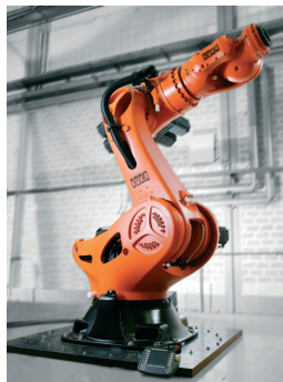
Obr.5 Príklady elektromechanických systémov: CNC rezací stôl, priemyselný robot s piatimi stupňami voľnosti
