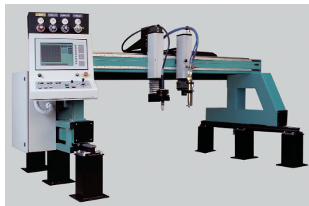
Obr.5 Príklady elektromechanických systémov: CNC rezací stôl, priemyselný robot s piatimi stupňami voľnosti
